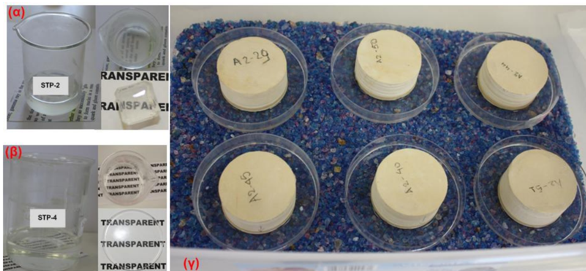
Σχήμα 7.5: Φωτογραφίες: (α), (β) των νανοϋλικών που εφαρμόστηκαν σε μορφή διαλυμάτων και τα πηκτώματα αυτών και (γ) από την εφαρμογή του υλικού STP-4 μέσω της διαδικασίας της τριχοειδούς αναρρίχησης.
