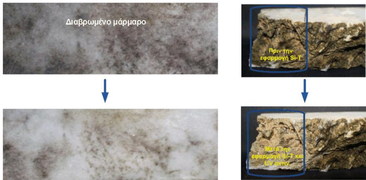
Σχήμα 7.13: Αυτό-καθαρισμός διαβρωμένων μαρμάρων, μετά την εφαρμογή του STP-1.
