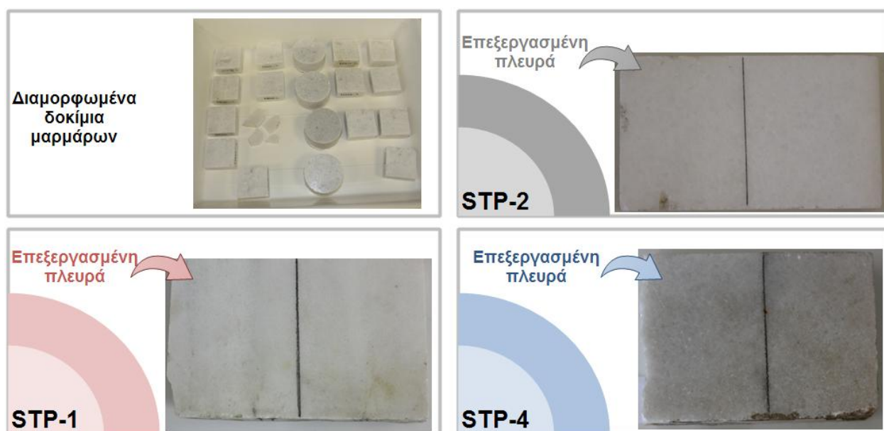
Σχήμα 7.2: Ενδεικτική φωτογραφία κατάλληλα διαμορφωμένων δοκιμίων μαρμάρων προς εφαρμογή των νανοϋλικών και μάρμαρα με επεξεργασμένα τη μισή τους επιφάνεια.
