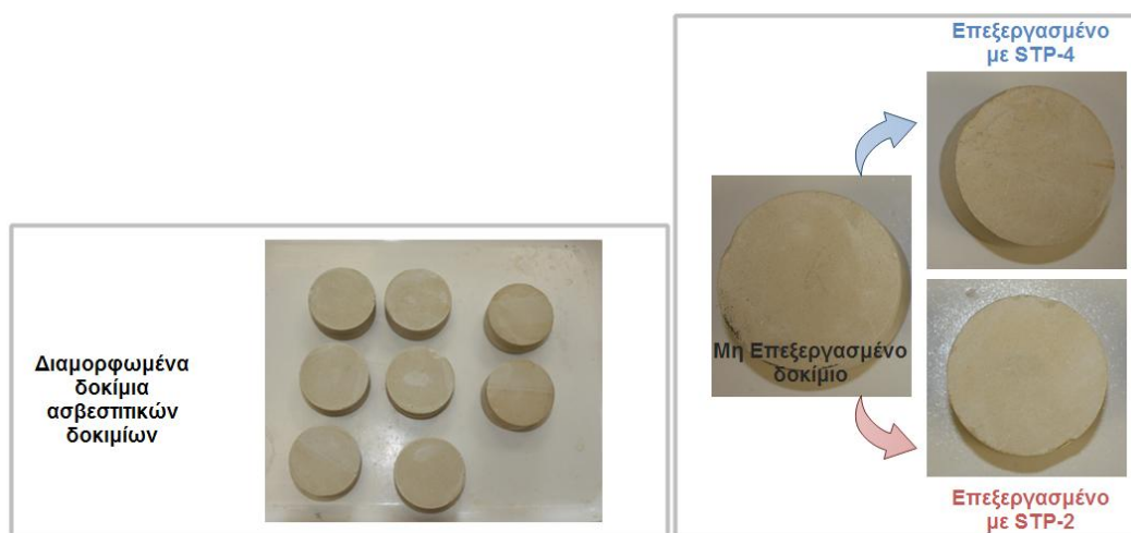
Σχήμα 7.4: Ενδεικτικές φωτογραφίες διαμορφωμένων δοκιμίων βιοκλαστικού ασβεστόλιθου (BCL) προς εφαρμογή των νανοϋλικών καθώς και των επεξεργασμένων επιφανειών τους.
