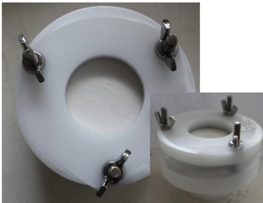
Σχήμα 4.18: Συσκευή μέτρηση διαπερατότητας σε υδρατμούς δομικών υλικών.
