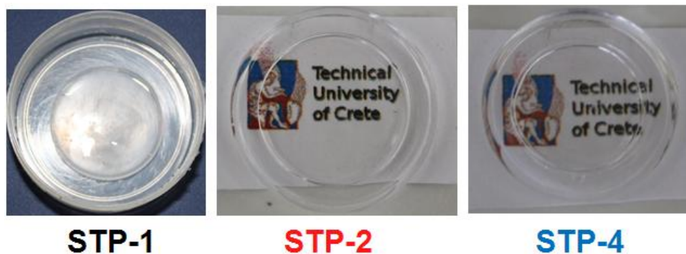
Σχήμα 6.1: Φωτογραφικές απεικονίσεις των xerogels, απαλλαγμένων από μικρορωγμές.
