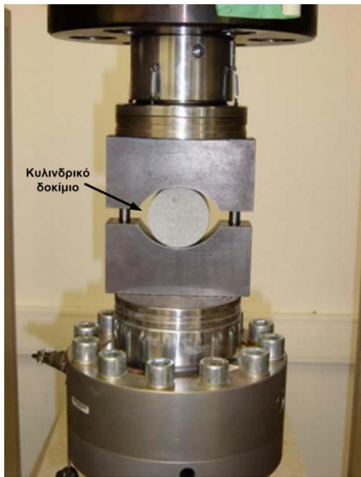
Σχήμα 4.20: Απεικόνιση δοκιμής έμμεσου εφελκυσμού (Brazilian test) [203].
