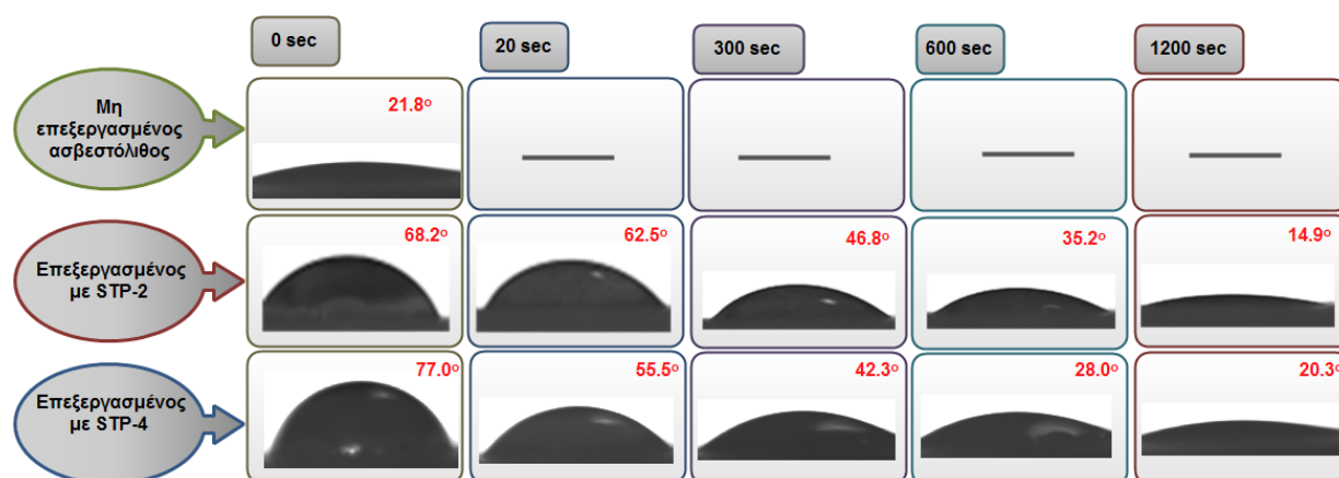
Σχήμα 7.14: Σχηματική αναπαράσταση σταγόνων νερού (CA) στις επεξεργασμένες και μη επιφάνειες ασβεστόλιθων.
